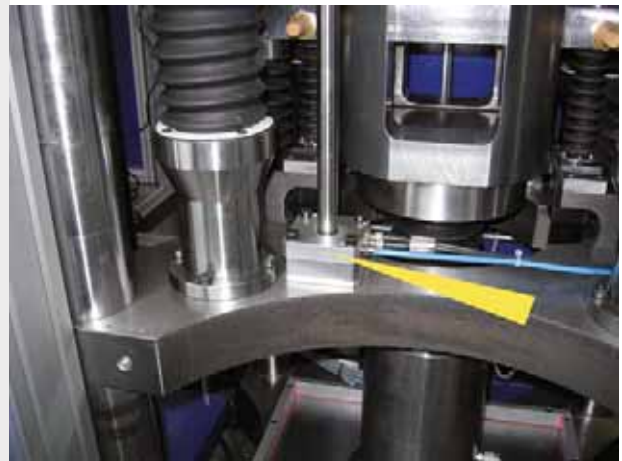
Le blocage de tige pneumatique permet d'utiliser des presses hydrauliques pour toute application KOMAGE Gellner Maschinenfabrik KG, 54427 Kell am See, Allemagne
